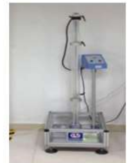
钢球冲击实验机 Falling roll impact Tester
